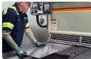
Corte con Cizalla
