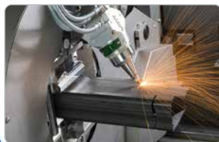
Corte con Láser de Tubos
